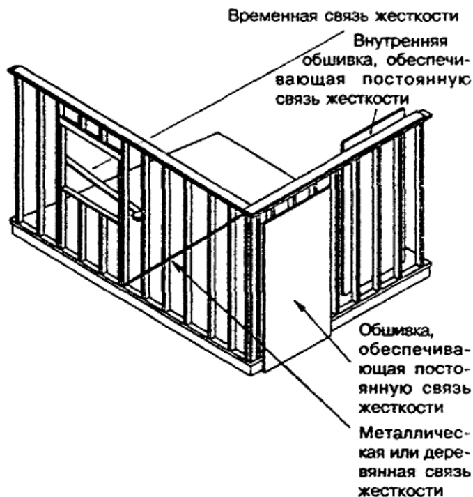
Рисунок 7.1 - Каркас стены
