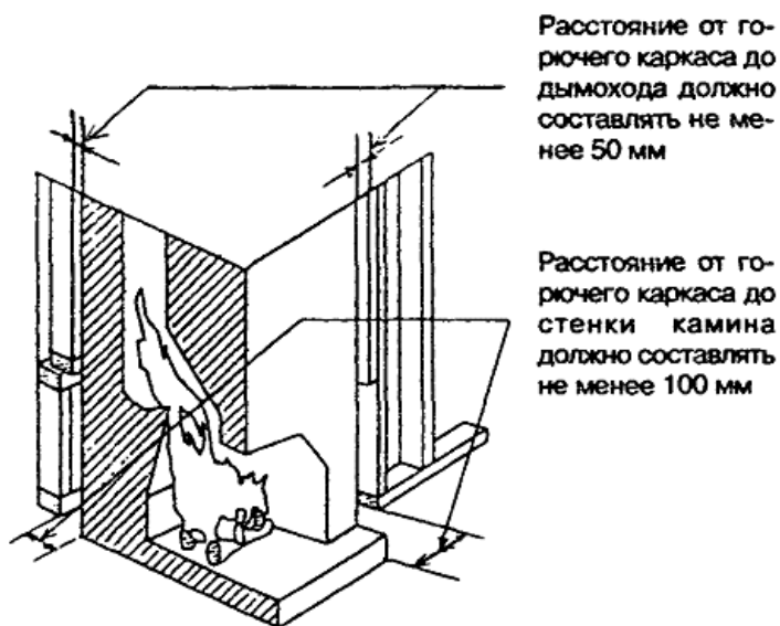
Рисунок 13.2 - Расстояние от стенок камина до каркаса здания
